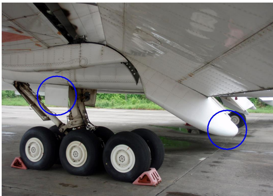
Rys. 6. Tabliczka znamionowa amortyzatora i końcówka owiewki lewego skrzydła.
