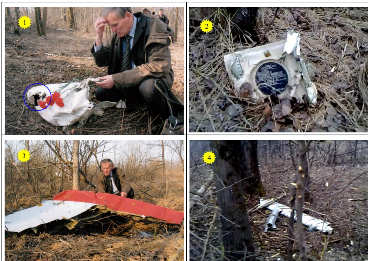
Rys. 4. 1) Owiewka napędu kłapy lewego skrzydła. Zdjęcie dra Jana Gruszyńskiego z dnia 11.04.2010. 2) Tabliczka znamionowa amortyzatora lewego podwozia. Kadr z filmu udostępnionego przez red. Anitę Gargas wykonanego w Smoleńsku w dniu 10.04.2010. 3) Część lewego statecznika poziomego. Zdjęcie dra Jana Gruszyńskiego z dnia 11.04.2010. 4) Interceptor (deflektor) z lewego skrzydła. Kadr z filmu udostępnionego przez red. Anitę Gargas wykonanego w Smoleńsku w dniu 10.04.2010
